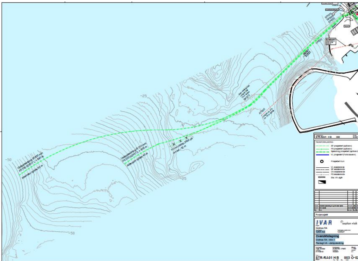
Figur 17. Planlagt utslippsledning fra nytt renseanlegget i Grytnes (utsnitt fra tegning oversendt fra oppdragsgiver, datert 27.1.2021).
